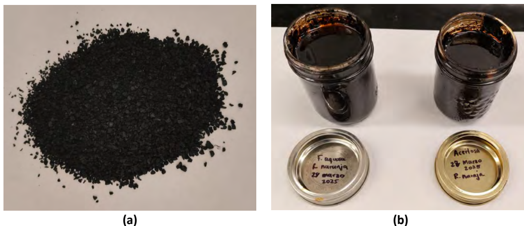
Figura 2. Fases obtenidas a partir de la pirólisis a) Fase sólida (biochar) y b) Fases aceitosa y acuosa
