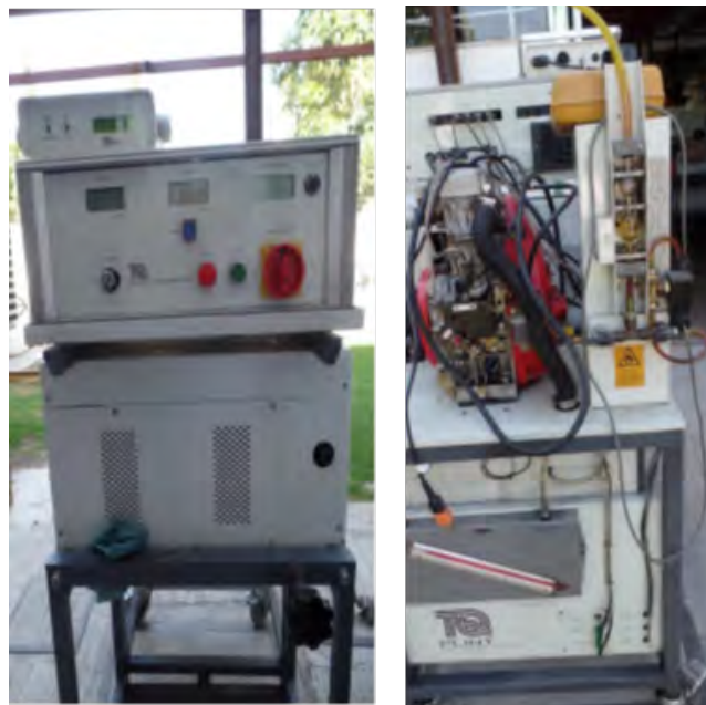
Figura 1. Motor diésel acoplado a un dinamómetro.
