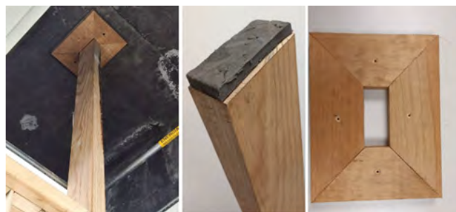
Figura 7. Junta articulada a fuerza axial vertical.
