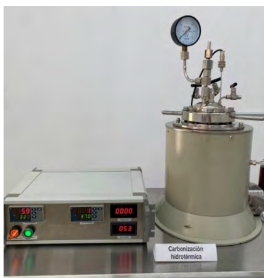
Figura 1. Reactor de carbonización hidrotérmica
