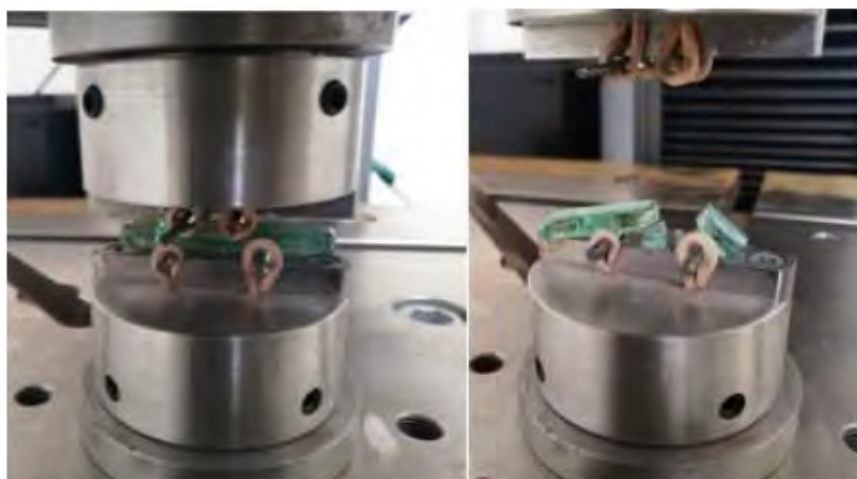
Figura 16. Prueba de flexión de cuatro puntos al inicio de la prueba (izquierda) y después de alcanzar la fuerza máxima (derecha)
