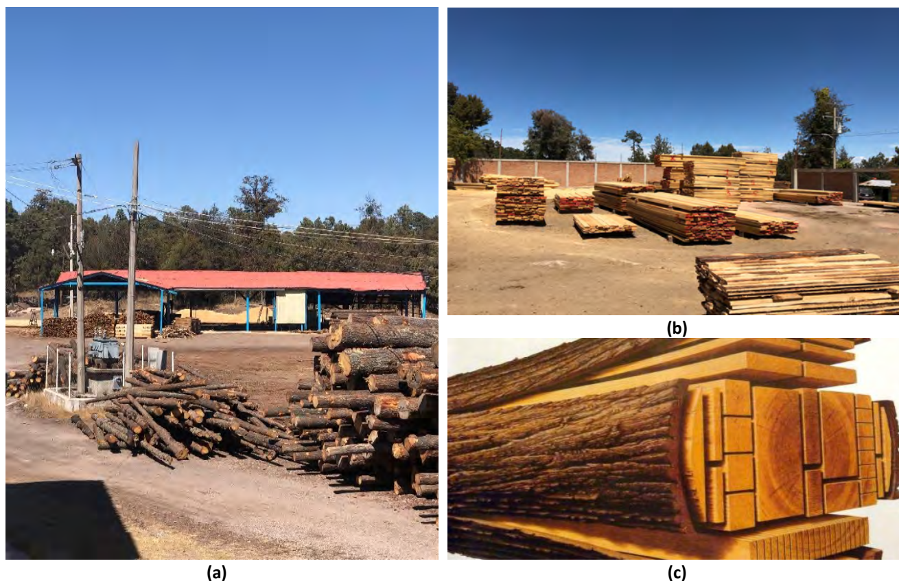
Figura 2. Aserradero Industrias Quintana en la región de El Salto, Durango. a) En el primer plano se observa la trocería, al fondo se distingue las instalaciones de la línea de producción. b) Patio de madera para escuadría. c) Esquema de despiece del trozo para obtener madera para escuadría
