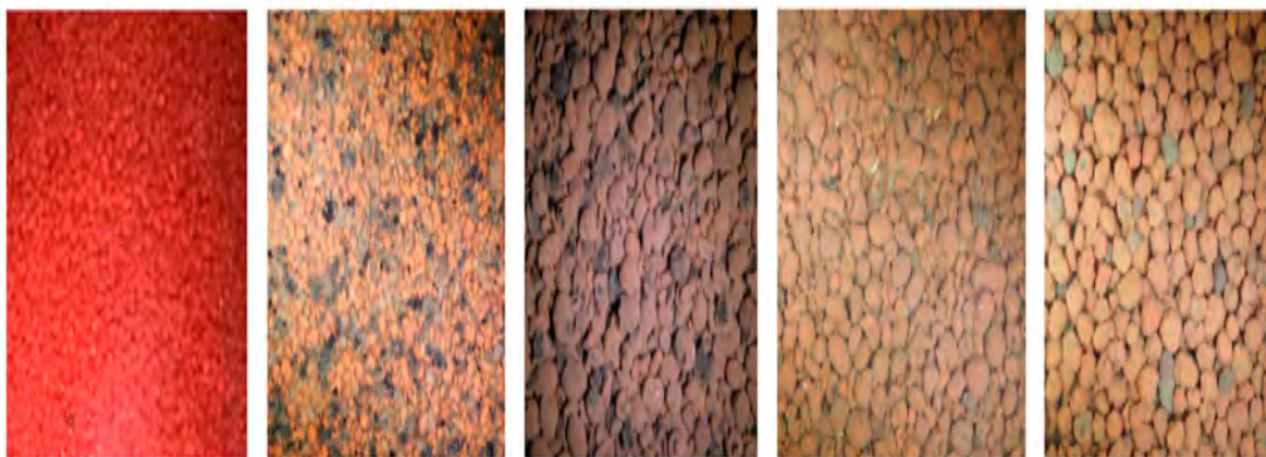
Figura 3. Gránulos de ANAMMOX en reactores de tratamiento de aguas residuales Fuente: Driessen & Hendrickx (2021)
