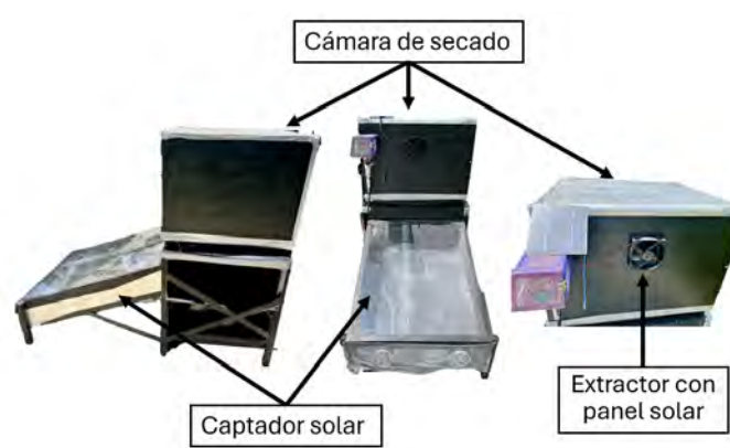
Figura 2. Secador solar construido a partir de residuos de mobiliario de oficina.
