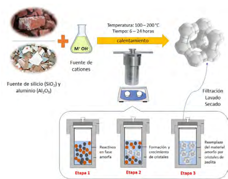
Figura 2. Síntesis de zeolitas a partir de residuos de la construcción y la demolición mediante el método hidrotermal. Elaboración propia a partir de Czarna-Juszkiewicz et al. (2020).
