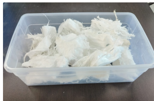
Figura 1. Fragmentación y reducción de tamaño de residuos de EPS como etapa previa para su reciclaje.
