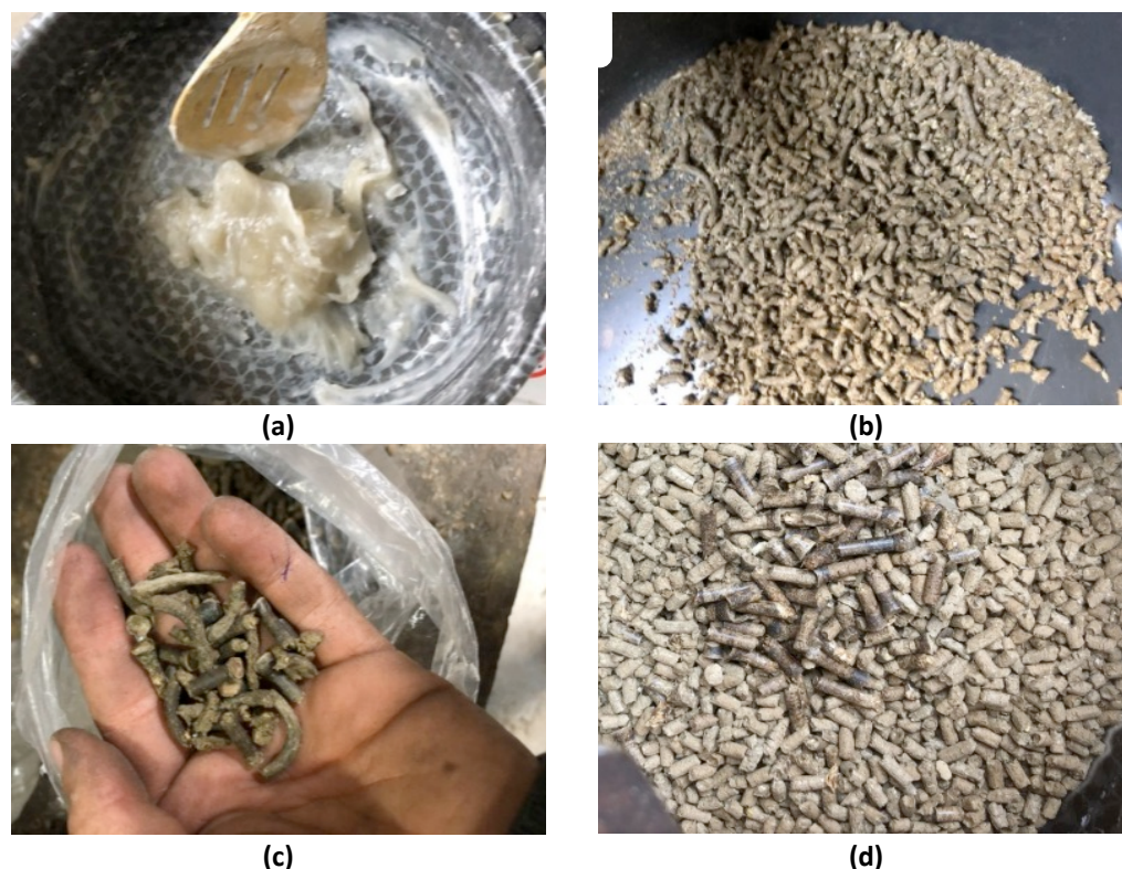
Figura 4. Producción de pellets con diferentes dosis de aglutinante; a) aglutinante, b) pellets concentración aglutinante 10%, c) pellets concentración aglutinante 5%, d) pellets concentración aglutinante 2%.
