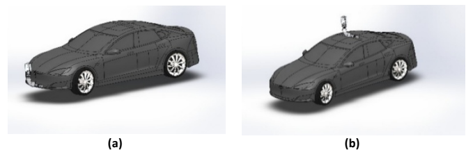
Figura 2. Ubicaciones de la turbina híbrida en un VE: (a) parte frontal del VE y (b) parte superior del VE.
