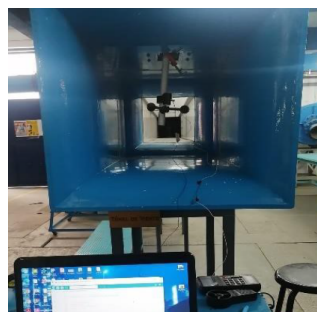
Figura 1. Caracterización de sensores tipo anemómetros de cazoletas en el túnel de viento a distintas velocidades controladas
