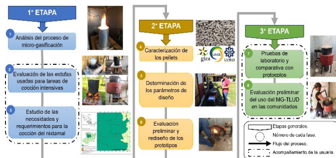
Figura 1. Diagrama de flujo que ilustra la metodología empleada en el desarrollo de los prototipos de MG-TLUD
