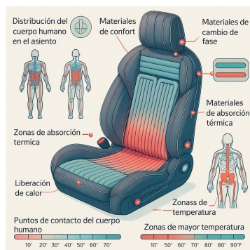
Figura 1. Representación conceptual de un sistema de gestión térmica pasiva en asiento automotriz con PCM. Modificada por el autor a partir de generación asistida mediante inteligencia artificial.
