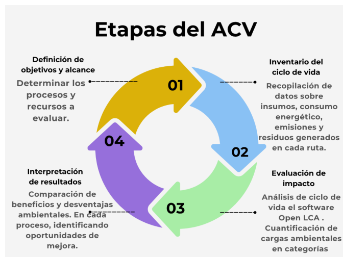
Figura 1. Representación de las etapas del análisis del ciclo de vida utilizada para la síntesis verde de \text{TiO}_2 .
