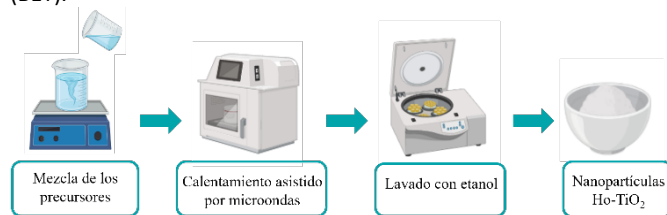
Figura 1. Proceso de síntesis hidrotermal asistida por microondas para el dopaje de \text{TiO}_2 con Holmio.
