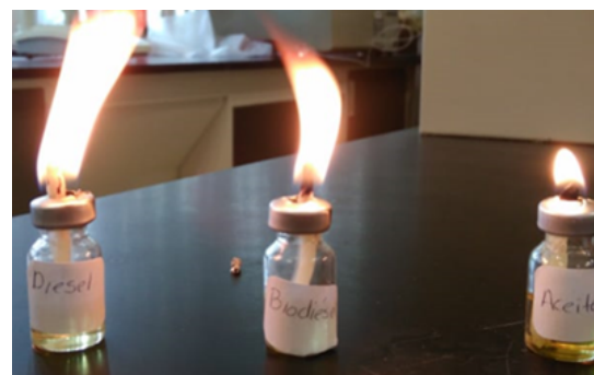
Figura 3. Prueba de flama comparativa, diésel, biodiésel y aceite usado
