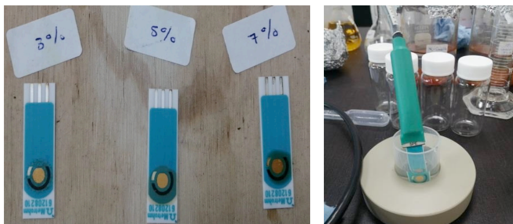
Figura 1. Electrodo de Au con NC-Fe%
