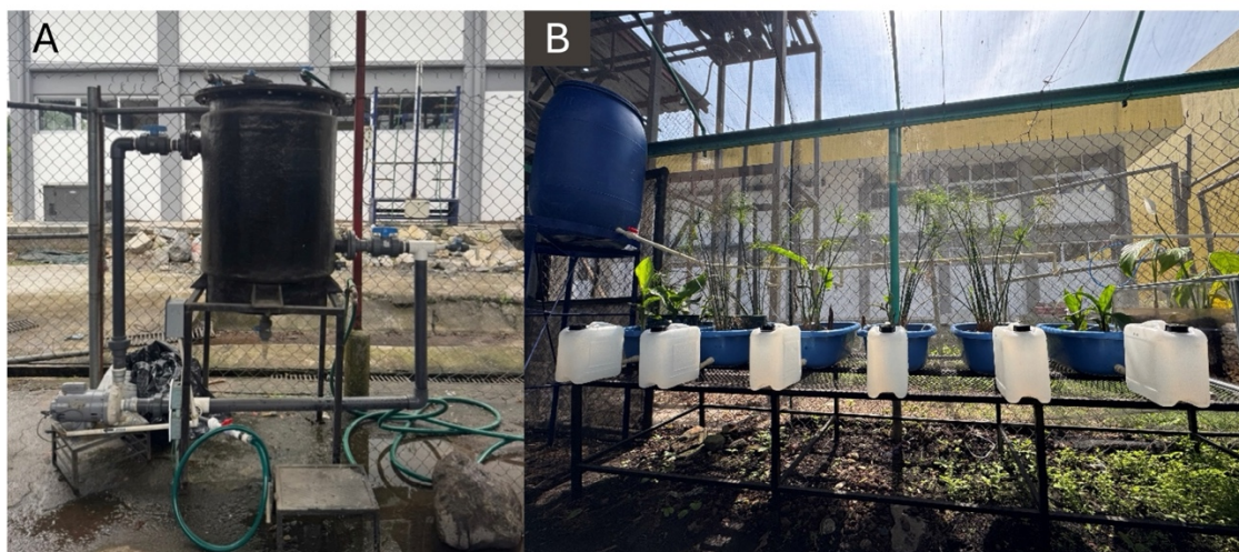
Figura 2. Sistema híbrido FBBR + HC-BF. (A) Reactor anaerobio de biopelícula fija; (B) Humedales construidos con biopelícula fija.
