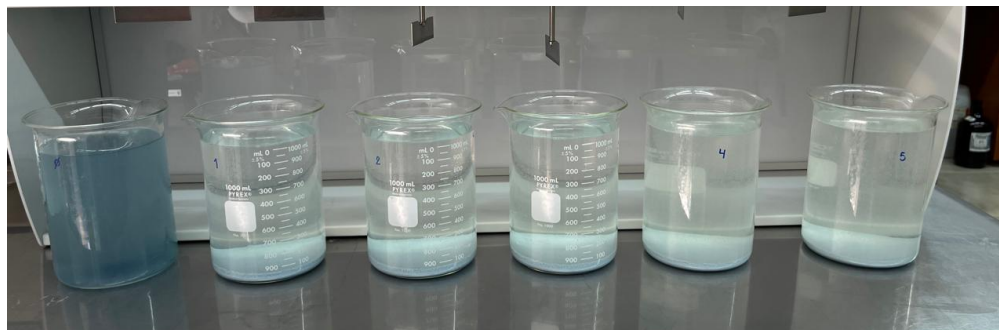
Figura 4. Prueba de coagulación-floculación de la Prueba 2
