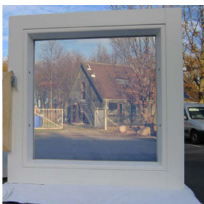
Figura 4. Acristalamientos superaislantes basados en el uso de placas de AS de AIRGLASS AB (Koebel et al. , 2012).
