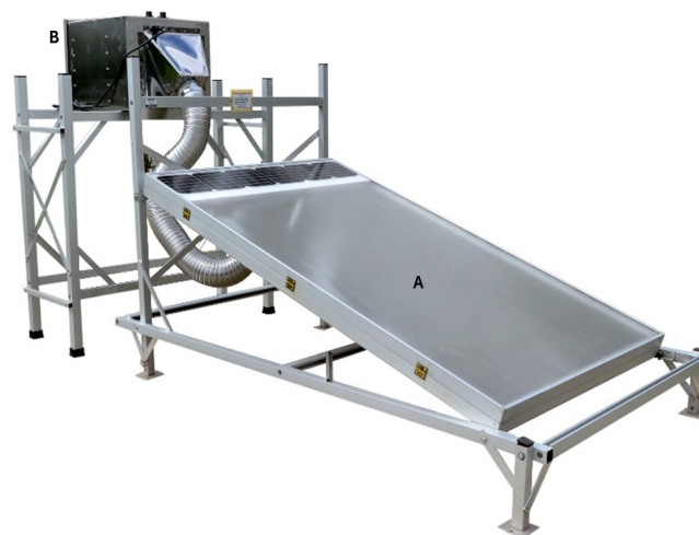
Figura 4. Sistema de secado solar con colector de doble paso (Desarrollado en CIIDIR-Oaxaca), a) Colector solar con panel fotovoltaico y b) cámara de secado (patente del Instituto Politécnico Nacional, Mx/u/2023/000266).
