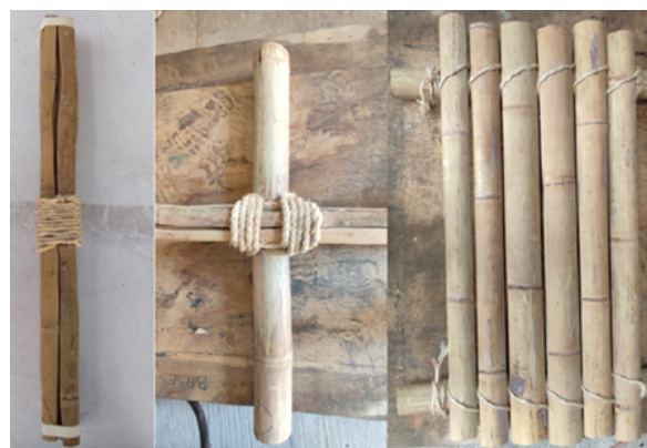
Figura 6. Tres tipos de amarres con mecate: barrilete, cuadrado y lateral.
