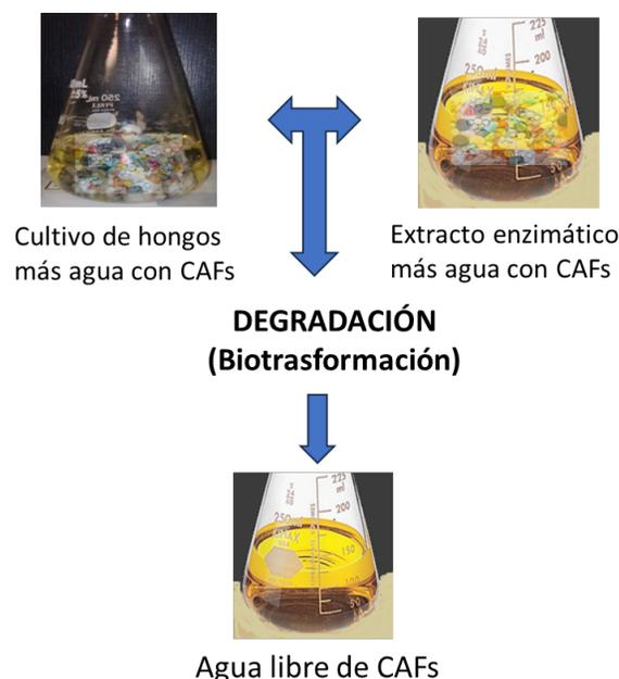
Figura 3. Ejemplo de la degradación de fármacos, carbamazepina, con cultivo de hongo y con el extracto enzimático libre de hongo. En ambos casos se presentan los dos mecanismos de degradación, (óxido-reducción y polimerización) en diferente proporción, de acuerdo con el hongo empleado, el tipo de fármaco, las condiciones de cultivo y las características del extracto enzimático obtenido del cultivo del hongo.
