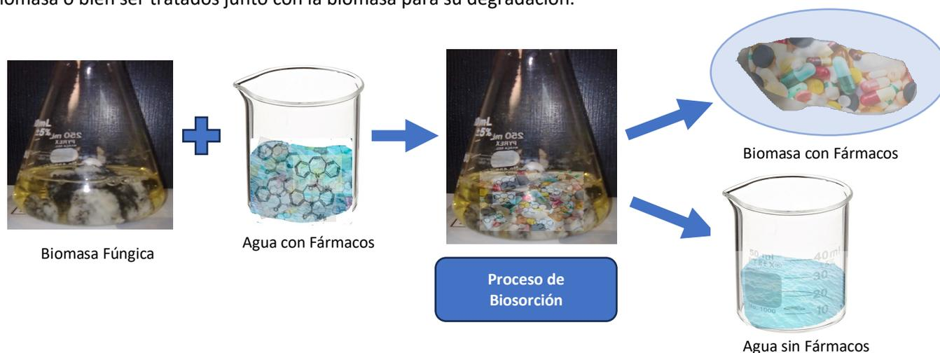
Figura 2. Esquema del proceso de biosorción de fármacos por biomasa húmeda de un hongo filamentoso.
