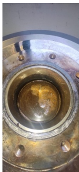
Figura 1. Residuo y agua dentro del reactor de carbonización.
