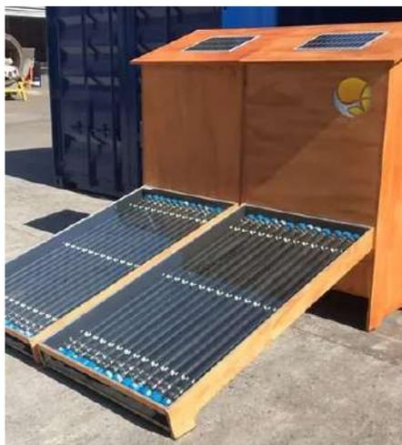
Figura 2. Imagen correspondiente al Secador de Frutas de 40K con almacenamiento térmico
