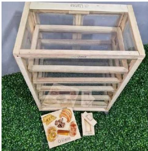
Figura 4. Imagen correspondiente a Uatza Deshidratador solar de Alimentos
