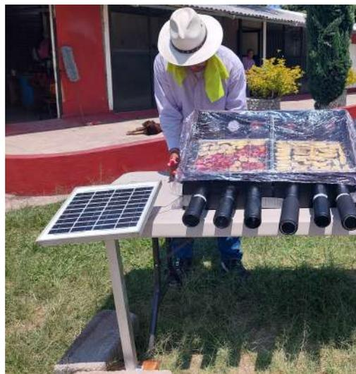
Figura 11. Imagen correspondiente al tercer prototipo de deshidratador aumentando el sistema de temperatura constante.
