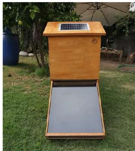
Figura 3. Imagen correspondiente al Secador de Frutas de 7K con almacenamiento térmico
