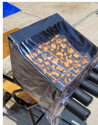
Figura 8. Imagen correspondiente al segundo prototipo de deshidratador pero experimentando con la fruta.
