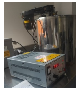
Figura 1. Bomba Calorimétrica marca P.A. Hilton LTD, modelo C200.
