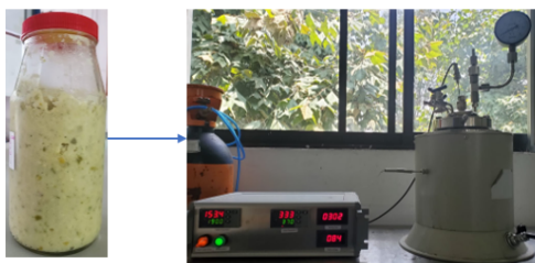
Figura 1. Reactor de carbonización hidrotérmica.
