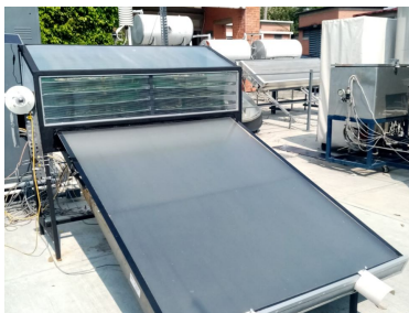
Figura 1. Secador solar tipo mixto utilizado en el proceso de secado de flor Gasparito
