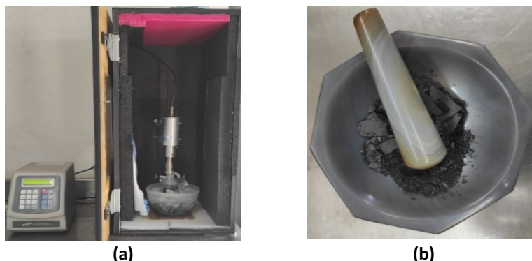
Figura 1. Proceso de obtención de nanoplaquetas de grafeno; (a) Exfoliado de grafito explotado; (b) Secado y pulverizado de nanoplaquetas de grafeno.
