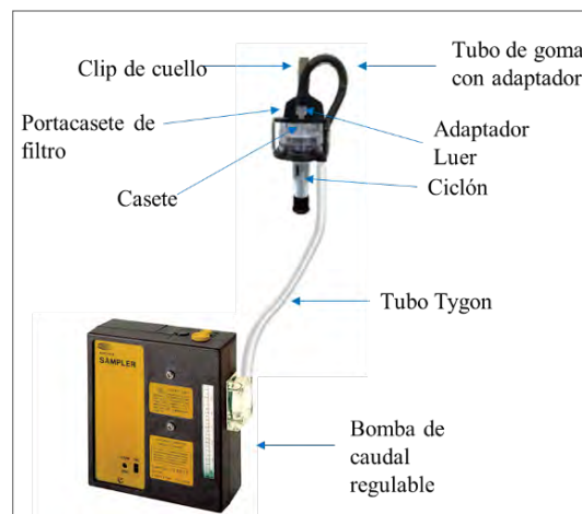
Figura 2. Tren de muestreo
