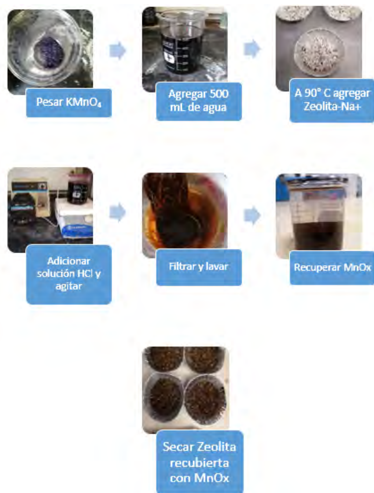
Figura 2. Esquema general del proceso de síntesis para la zeolita recubierta con MnOx.
