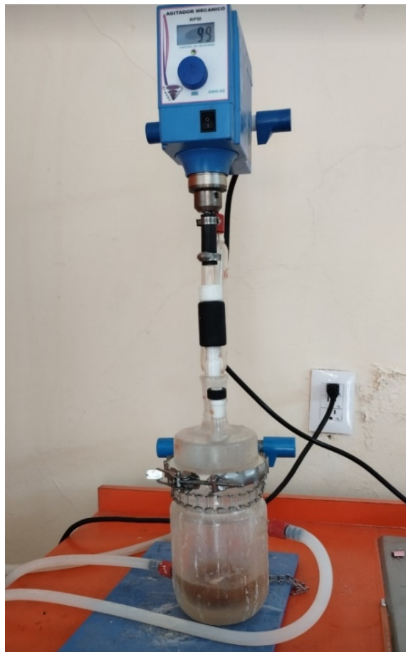
Figura 1. Reactor de vidrio enchaquetado con control de temperatura y agitación.
