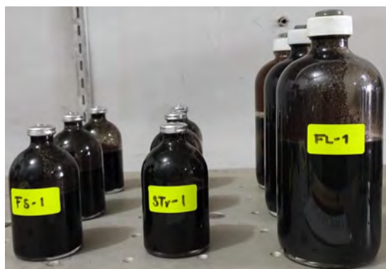
Figura 4. Pruebas para evaluar el Potencial Bioquímico de Metano (PBM): FS, STR y FL.
