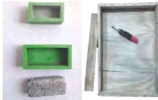
Figura 3: Molde de bloques de cemento y polvo, para construcción de las paredes del prototipo y base para el cimientado.
