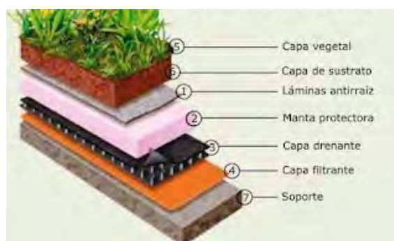
Figura 6. Capas del techo verde extensivo (Ramón, 2018).
