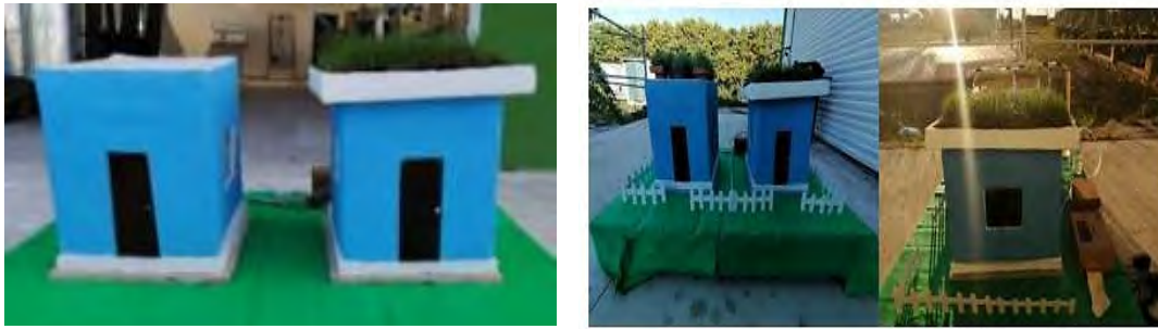
Figura 6. Prototipos utilizados para la investigación: techo plano convencional, techo verde extensivo y techo verde modular ubicados en el taller de energías renovables del TecNM Campus Progreso.
