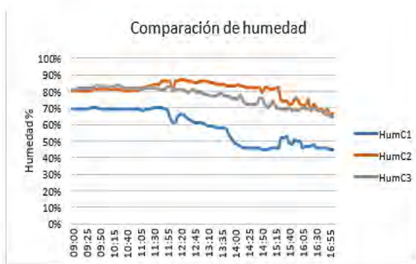
Figura 9. Datos de comparación de la humedad entre los tres tipos de modelos implementados donde: HumC1 es “techo verde extensivo”, HumC2 “techo plano” y HumC3 “techo verde modular”.
