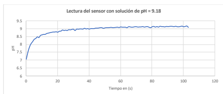
Figura 5. Gráfica de la medición de pH vs t para la solución de pH 9.18.
