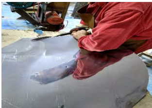
Figura 5. Corte de lámina de acero inoxidable
