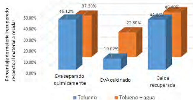
Figura 2. Porcentaje de EVA separado y celda recuperada respecto a la muestra reciclada.
