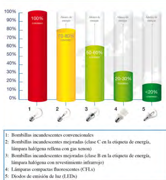
Figura 1. Comparación de ahorro energético vs. consumo eléctrico de diferentes tipos de lámparas.
