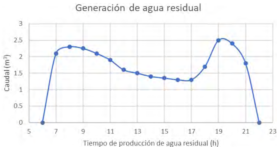
Figura 7. Estimación de las variaciones horarias en el caudal del agua residual generada en las instalaciones del Instituto Tecnológico Superior de Martínez de la Torre
