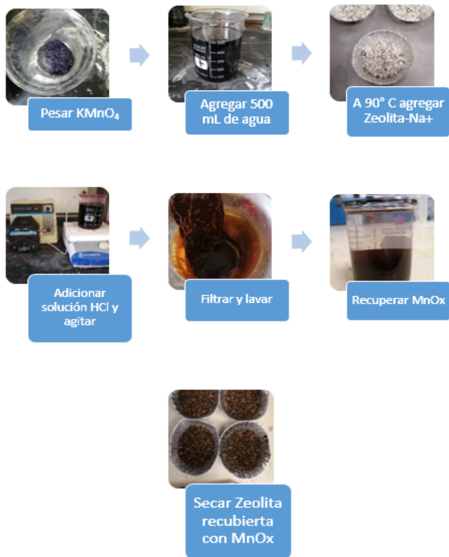
Figura 2. Esquema general del proceso de síntesis para la zeolita recubierta con \text{MnOx} .
