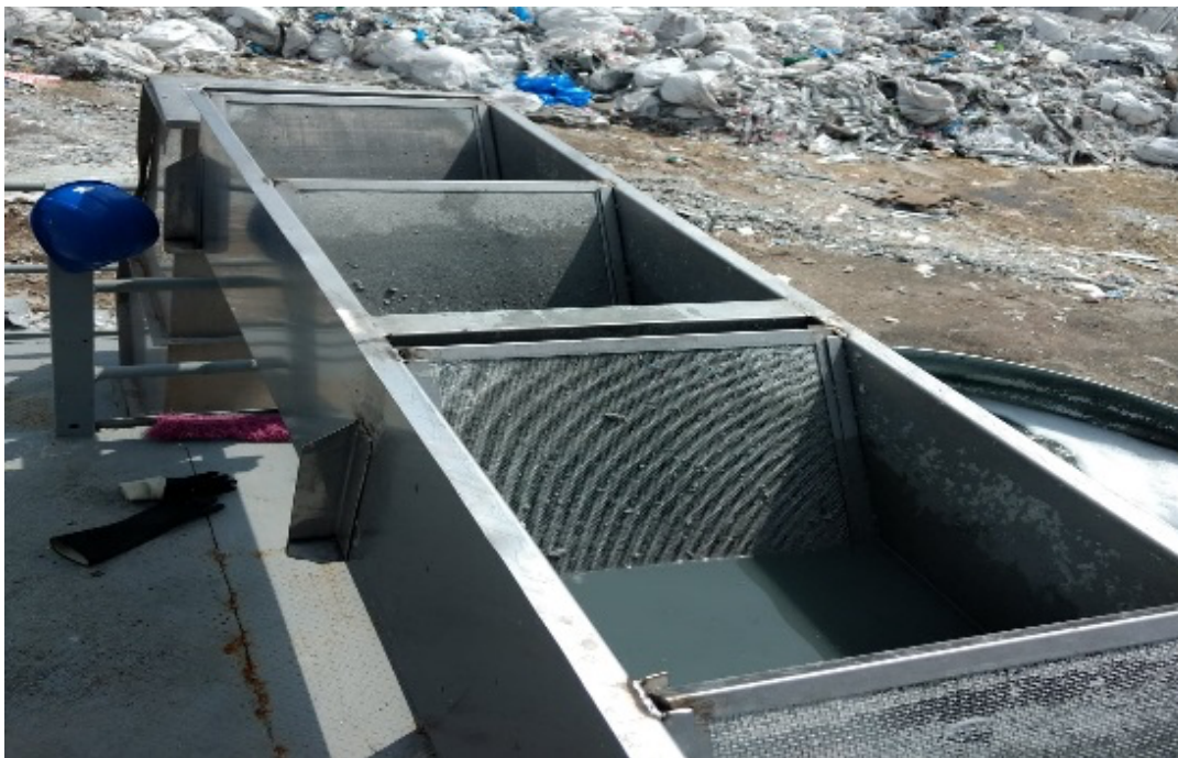
Figura 2. Operación unitaria de cribado
